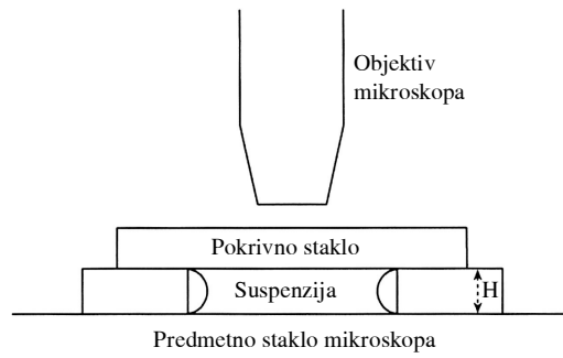
Slika 1.2.4 Perenova aparatura za merenje raspodele čestica u suspenziji.
